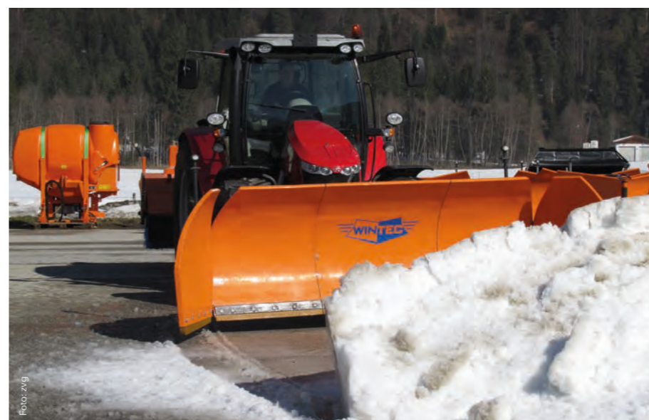
KK-Schilder eignen sich besonders, um Flächen komplett vom Schnee zu befreien. Durch Herabsenken der Seitenteile lässt sich der Schnee gezielt bewegen.
