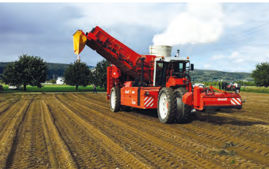
Kurt Märki récolte des pommes de terre avec une récolteuse automotrice à deux rangs dans les cantons Bâle-Campagne et Argovie.
