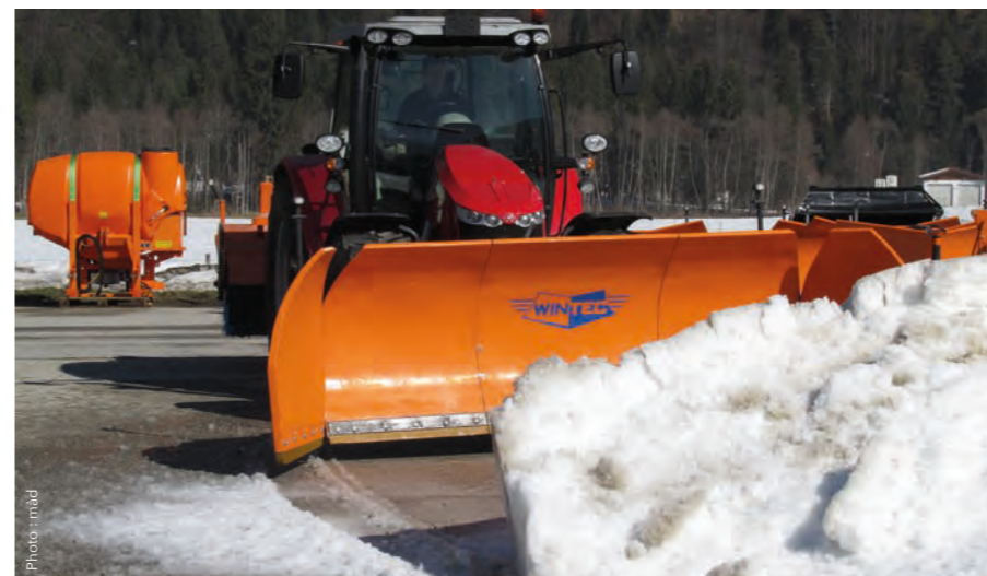
Les lames à volets latéraux sont particulièrement adaptées pour le nettoyage complet des surfaces. En abaissant les volets latéraux, la neige peut être déplacée de manière ciblée.
