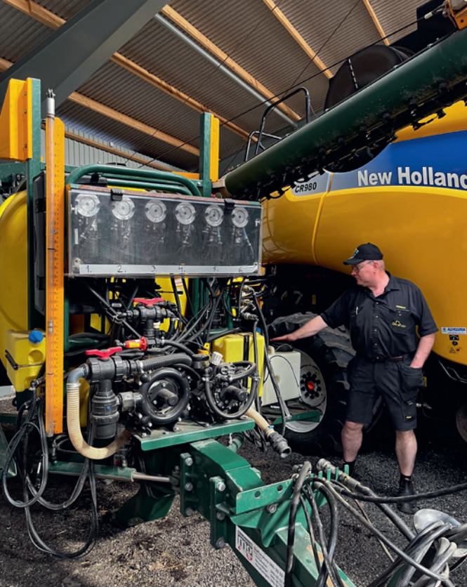
Protection des cultures avec le Danfoil équipé de six pompes qui dosent. Largeur de travail 24 m.
