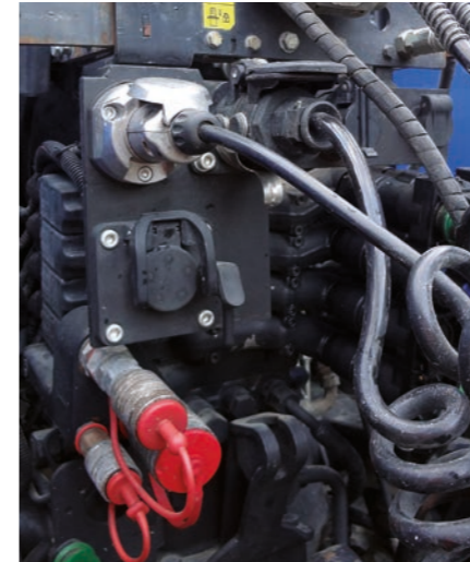
Anhänger mit EBS können auch mit Traktoren ohne ABS eingesetzt werden, wenn diese über eine Stromversorgung nach ISO 7638 verfügen (oben rechts).
