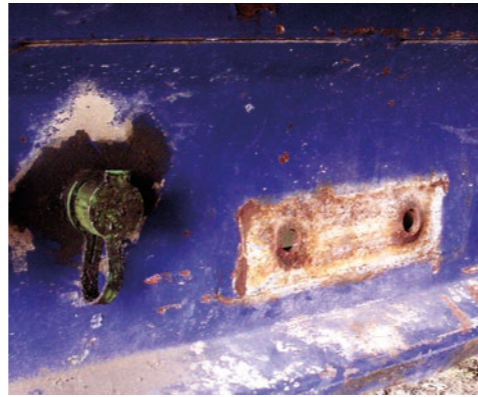
Auch bei neuen Anhängern muss auf eine korrekte Einbindung der Anhängervorrichtungen (hinten) ins Chassis geachtet werden, damit diese im Einsatz nicht abgerissen werden.
