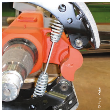
S-Nocken weisen eine gute Kinematik und eine grosse Spreizung auf.
