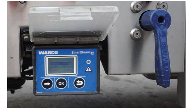
Bedien- und Anzeigeterminal eines elektronisch geregelten Bremsystems EBS.
