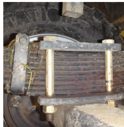
Diese Achse ist nicht korrekt in das Federpaket eingebunden, die Schweißnähte liegen zudem an unzulässigen Stellen.
