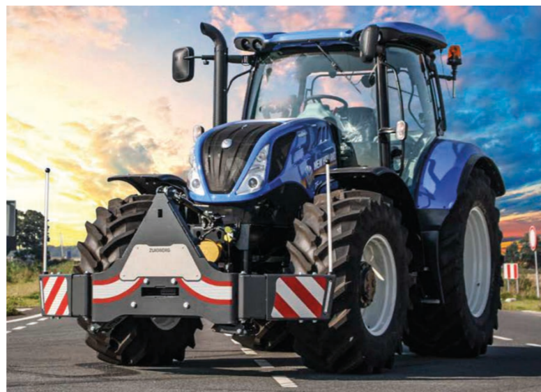
Les lests frontaux avec protection anti-encastrement et fonction de marquage renforcent la sécurité.
