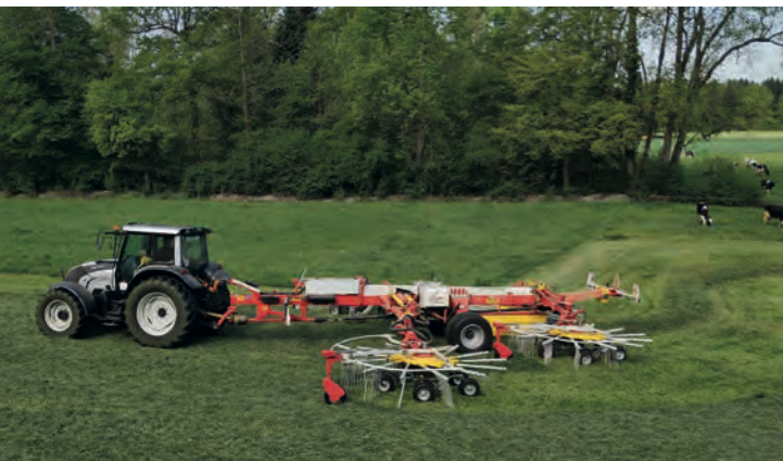
L'andaineuse à quatre rotors garantit une récolte rationnelle de l'ensilage d'herbe (à gauche), et grâce aux cinq ensileuses de marque CLAAS, chacune munie de un bec à maïs de six rangs, le maïs est récolté en un rien de temps (à droite).
