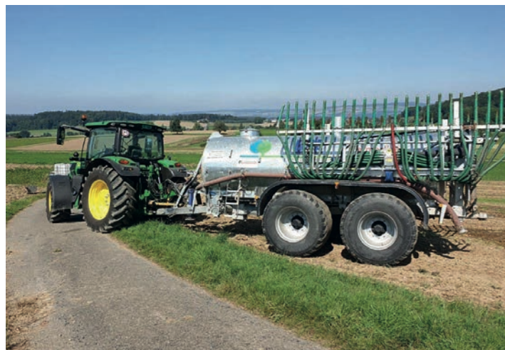
Le tonneau à lisier avec rampe à pendillards s'avère rentable. Entre 600 et 700 citernes sont épandues chaque année et la demande ne cesse d'augmenter.
