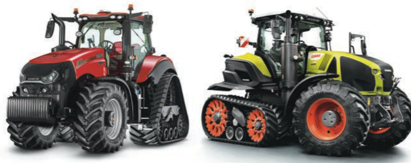
Avec le Magnum Rowtrac et l'Axion TerraTrac, Case IH et Claas proposent des tracteurs « half-track » qui assurent une grande polyvalence.
