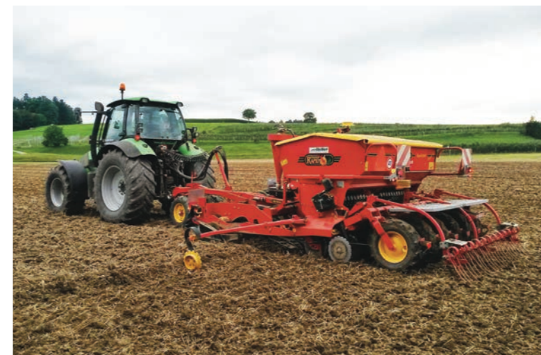
Par rapport aux outils portés par l'intermédiaire d'un dispositif trois points, les outils semi-portés ou traînés réduisent la charge sur les roues (arrière) du tracteur. Le lest frontal nécessaire peut être diminué, tout comme la pression de gonflage.
