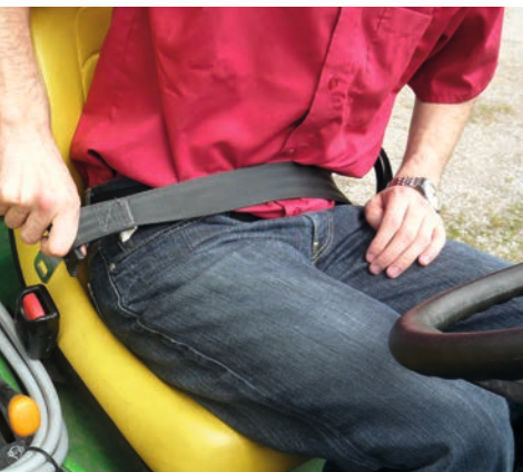
Les ceintures de sécurité 2 points avec enrouleur, ergonomiques et faciles à mettre, améliorent l'acceptation du port de la ceinture.
