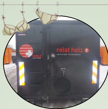
Container mit Zwischenboden für Getreide oder Holzschnitzeltrocknung mit Einblasstutzen.
