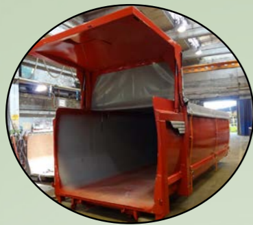
Hydraulische Heckklappe auch als Volumenklappe. Die ideale Abdeckung ist unsere Rollplane.
