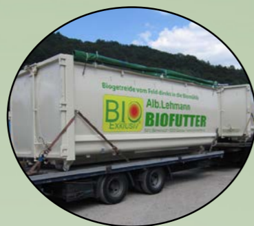
Abrollcontainer spantenfrei mit Rundung in der Seitenwand, auch Leichtbauweise oder mit Spanten [U-Profile]. Gestalten Sie mit uns Ihre gewünschte Kundenwerbung!
