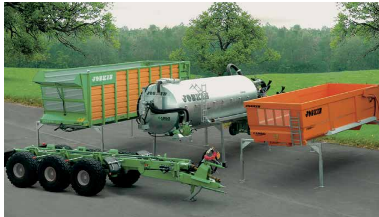
Durch den Einsatz mehrerer Aufbauten lässt sich das Fahrwerk ganzjährig auslasten.
