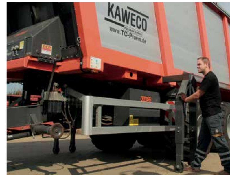
Wechselaufbauten werden beim Abbau meist auf stabilen seitlichen Stützen abgestellt.
