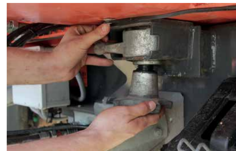
Die Verriegelung der Wechselaufbauten erfolgt meist mit sogenannten Twistlock-Verschlüssen.
