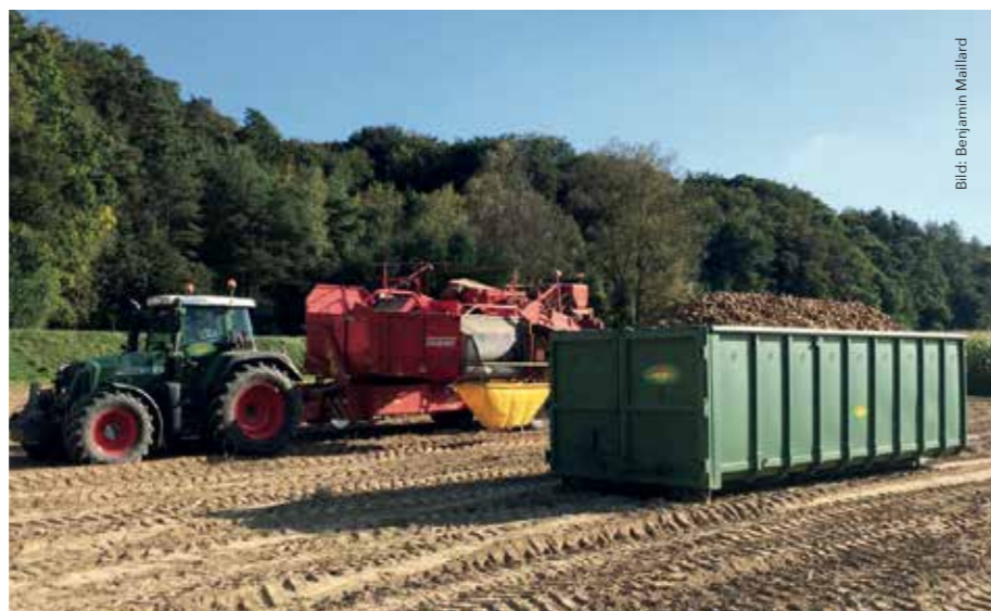
Hakenliftanhänger eignen sich vor allem bei Arbeiten, bei denen die Aufbauten stationär befüllt werden müssen.
