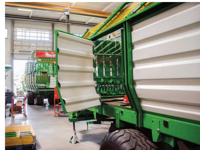
Dieser Ladewagen ist eine Sonderanfertigung mit Seitentüre für besseres Ein- und Aussteigen.
