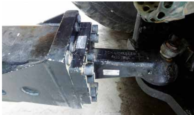
Seit Januar 2017 sind für K80-Zugkugelkupplungen Stützlasten bis vier Tonnen möglich. Die komplette Verbindungseinrichtung muss dafür aber ausgelegt sein und auch beim Zugfahrzeug gilt es mehrere Punkte zu beachten.
