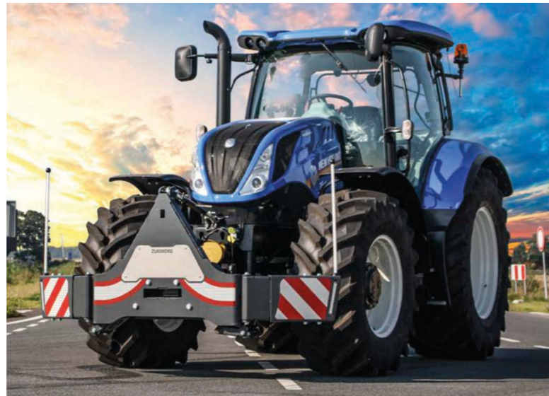
Frontgewichte mit Unterfahrerschutz- und Markierungsfunktion erhöhen die Sicherheit.
