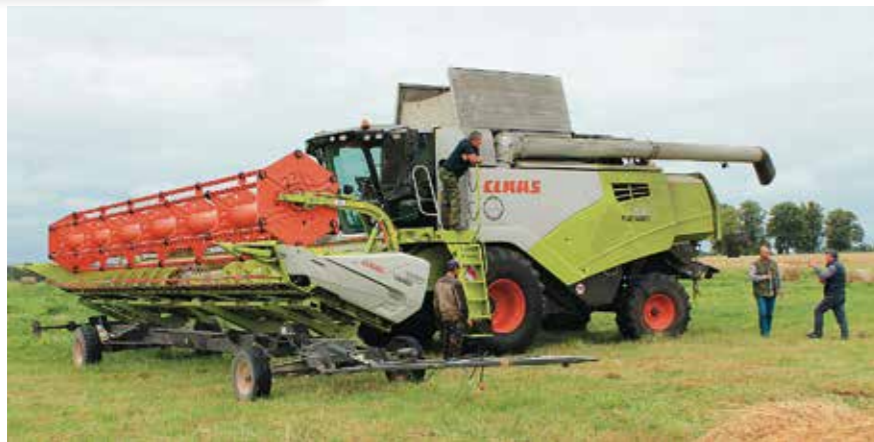
Auch auf russischen Strassen muss das Schneidwerk abgebaut werden.
