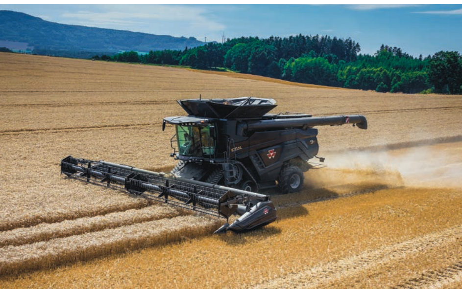
Bei Mähdreschern der oberen Leistungsklasse sind Raupenfahrwerke ein Muss. Sie vergrössern die Aufstandsfläche der Maschinen und ermöglichen es, die zulässigen Maschinenbreiten einzuhalten.
