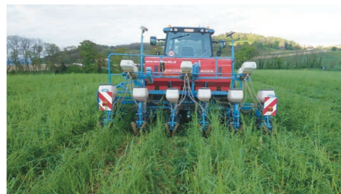
Mit den zwei Einzelkornsämaschinen säen die Christinats jährlich rund 250 ha. Diese Maschinen sind auch für die Direktsaat und Unterfussdüngung ausgerüstet.
