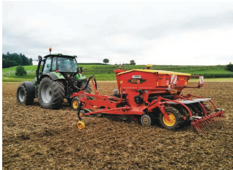
Aufgesattelte und gezogene Arbeitsgeräte führen im Vergleich zum Dreipunktbau zu einer reduzierten (Hinter-)Radlast am Traktor. Dies ermöglicht eine Reduktion des notwendigen Frontballastes und des Reifeninnendrucks.
