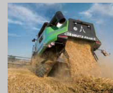
Die neue Serie C9300 hat eine neue Strohführung erhalten, mit der die Effizienz bei Langstroh verbessert und die Leistungsstärke des Strohhäckslers erhöht wird.
