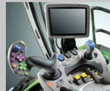
Neue Armlehne mit integriertem COMMANDER STICK und iMonitor.
