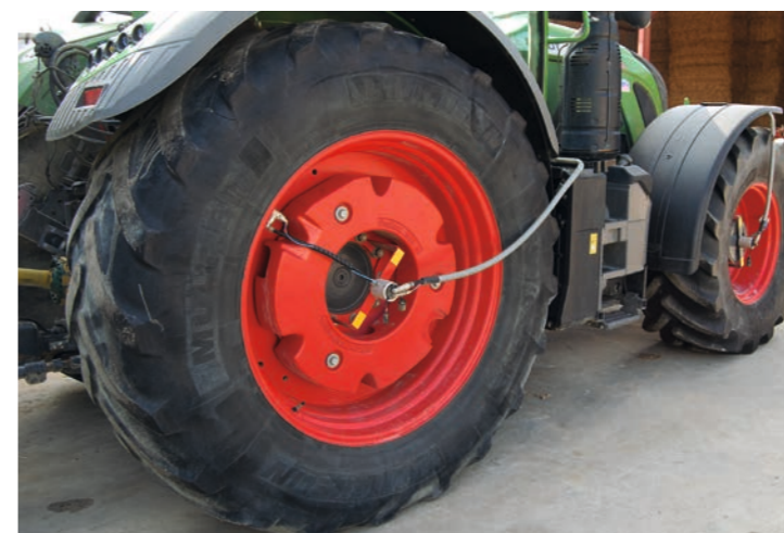
Die Reifendruckregelanlagen helfen die Böden zu schonen.
